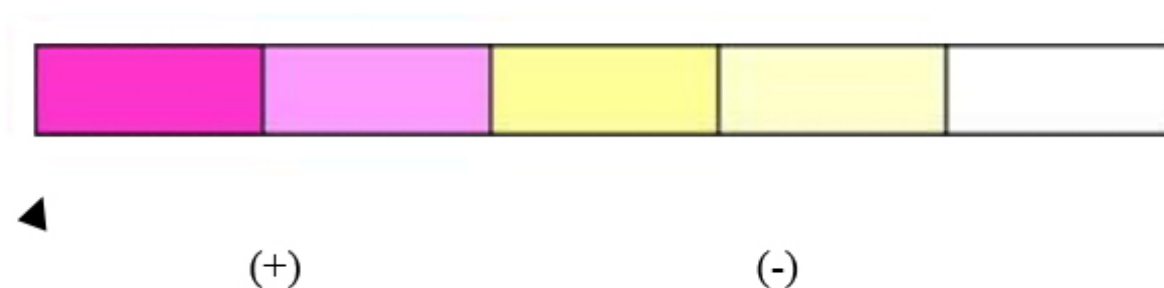
Gráfico 1. Patrón colorimétrico para medición de Nitratos en agua.
